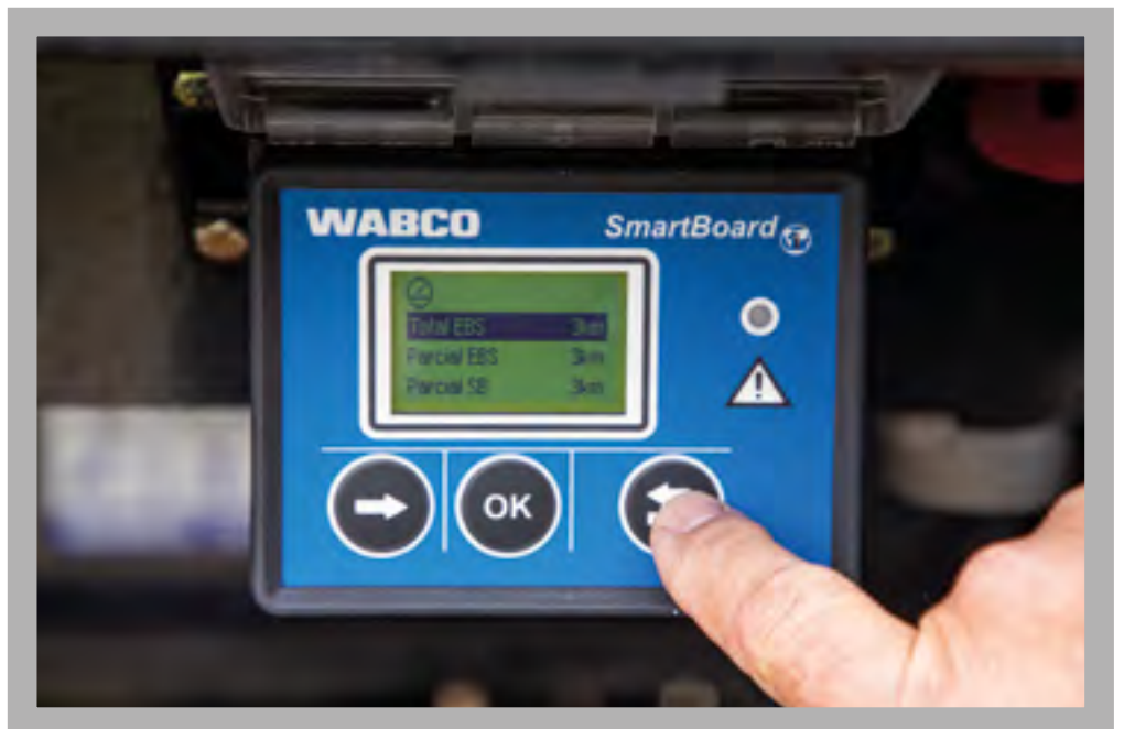
● SMARTBOARD: informa sobre Kms recorridos, porcentaje de Kms cargados y vacíos, peso de la unidad por eje, por tándem, completo y varios códigos de diferentes fallas posibles, entre otras cosas.
